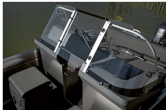
Pulpettien välinen kiinteä väliovi suojaa matkustajia viimalta ja roiskeilta.
