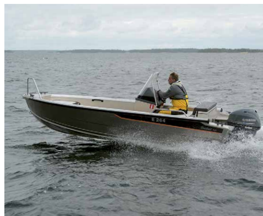
Nousulistaton runko nousee kevyesti plaaniin.
