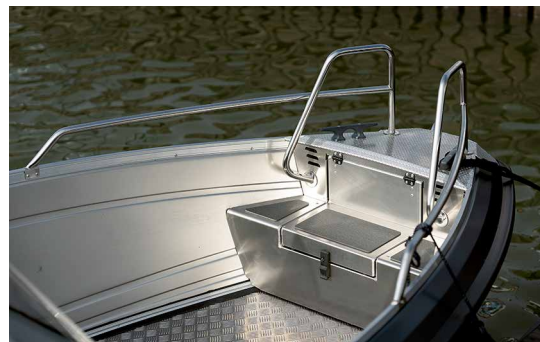
Tukevat keulakaiteet ja lukittava porraskaula liukastumista estävällä solumuovilla
