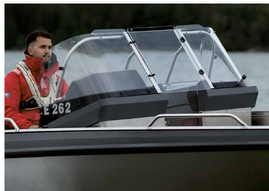
Pulpettien välinen kiinteä väliovi suojaa matkustajia viimalta ja roiskeilta.
