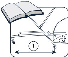
Kuomon kaariputkien kiinnityshelat kiinnitetään piirroksen tai annetun mitan mukaisille paikoille. Kiinnitä kaariputket heloihin.
