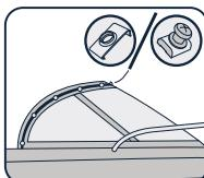
Jos veneen tuulilasin yläreunaprofiili on varustettu kiinnikeuralla, niin aloita kuomon asentaminen laittamalla uuraan tulevat kiinnikkeet ensimmäisenä paikoilleen.
