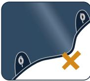
Kiristää kuomu tasaisesti, ja asenna kiinnikkeet paikoilleen siten, että kiinnikkeiden välillä ei jää pusseja.
